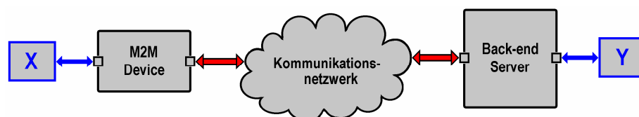
Abbildung 1.1: Grundkonzept einer M2M-Anwendung
